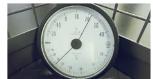
自動書庫内の温度計兼湿度計。本のためにも、空調の管理は欠かせない。ちなみに、書庫の中の空気はひんやりと涼しく保たれている。
